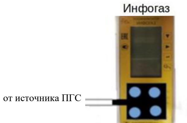
Рис. 3.1. Подача ПГС в адаптер при проверках
